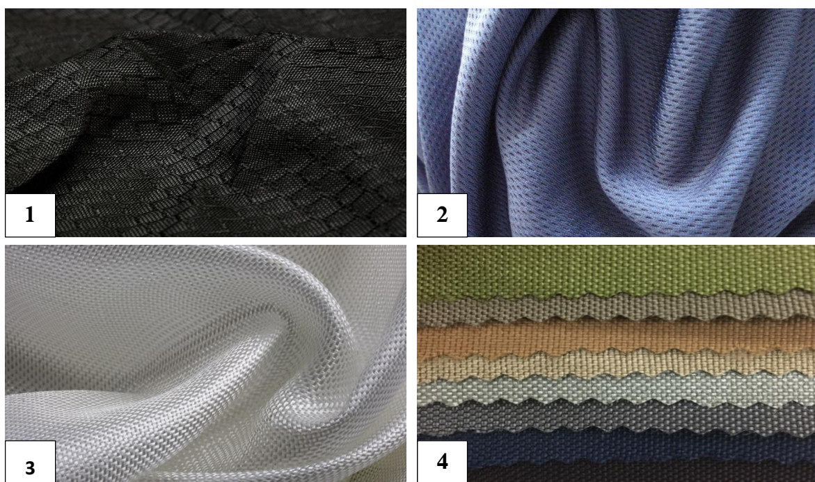
شكل رقم 16 يوضح أنواع الأقمشة المركبة ذات المميزات المتعددة وأهمها عدم الإحترق أو التمدد - (1) سبكترا فيبر - (2) البوليستر - (3) الفيبر جلاس - (4) النايلون
