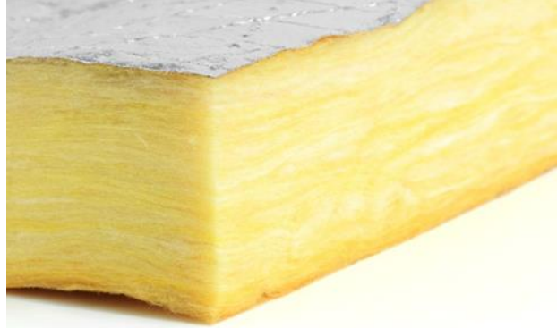
شكل رقم (5) يوضح نواه الألواح الجدارية اللينة الصوف الزجاجي
