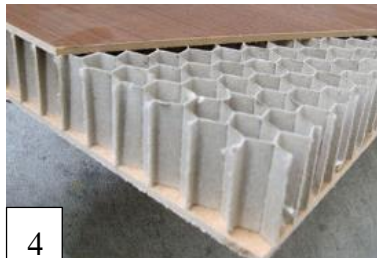
شكل رقم (7) يوضح الأنواع المختلفة للنواة الأساسية لألواح الساندوتش (1 مواد رغوية - 2 فوم - 3 صفائح مموجة - 4 خلية نحل هاني كومب) ورقية - 5 خلية نحل هاني كومب) من الألومنيوم - 6 الخشب
